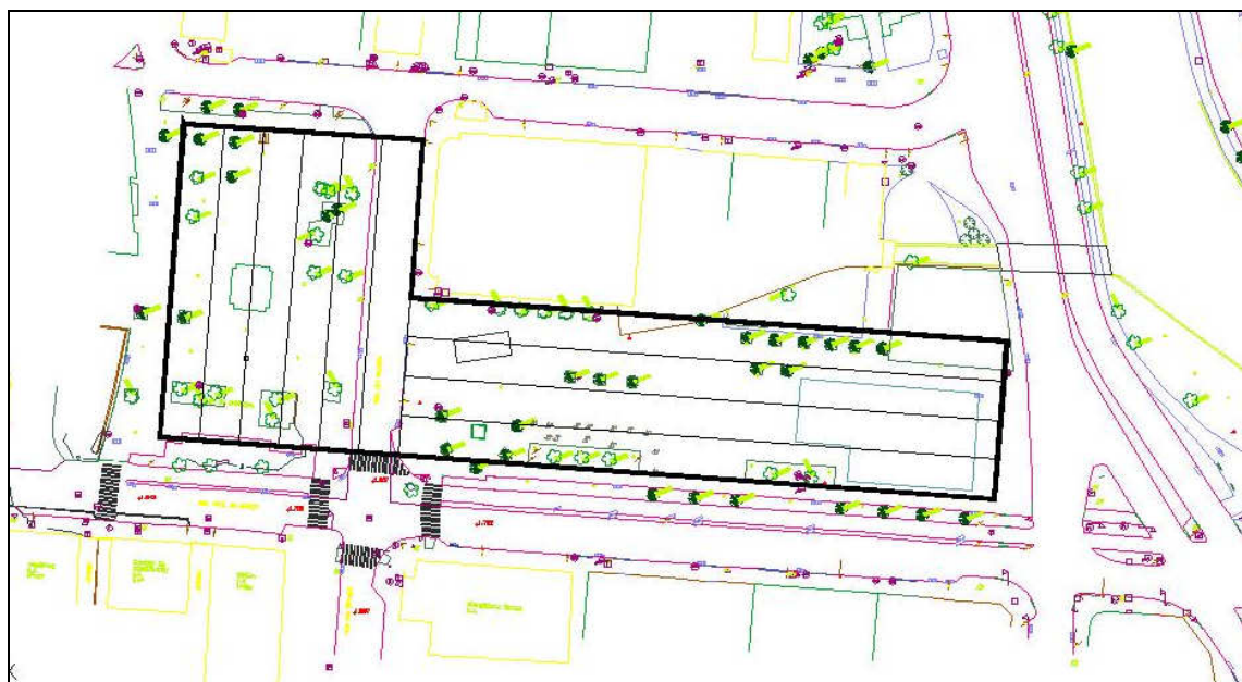
Figura 14 – Arranjo da bacia de detenção na praça.
